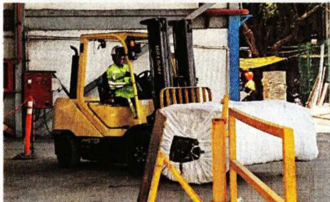
Las lonas y pendones son comprimidos en pacas, para su uso como Combustible Derivado de Residuos, en los hornos.
