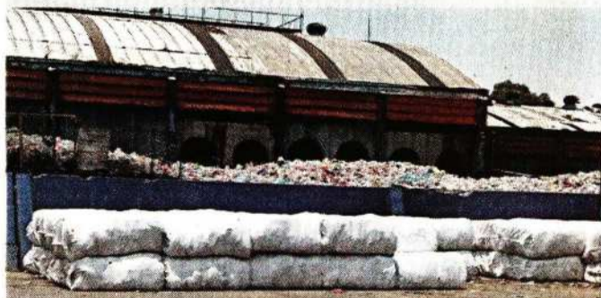
Las pacas son colocadas dentro de costales para evitar que los residuos se separen en el traslado.
